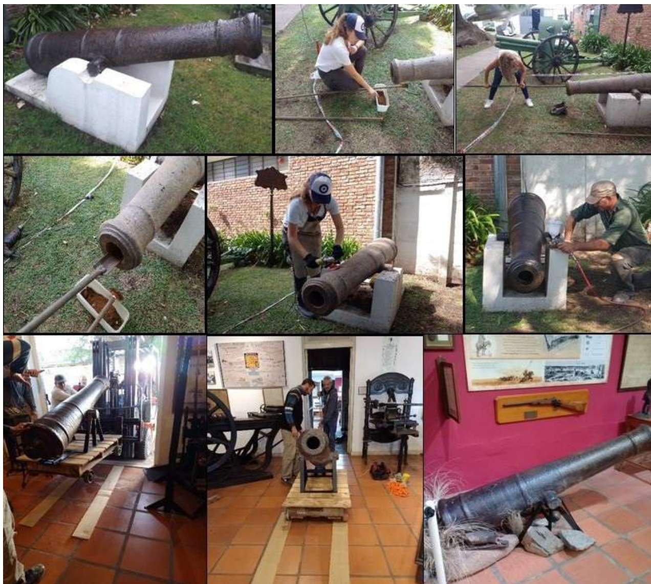
Figura 8. Limpieza, restauración y estudio del cañón FCS.FI.640, donde se analizó el material que se encontraba en el interior y la estructura del ánima. Colocación posterior en una sala temática del Museo. Fotografías de los autores.
